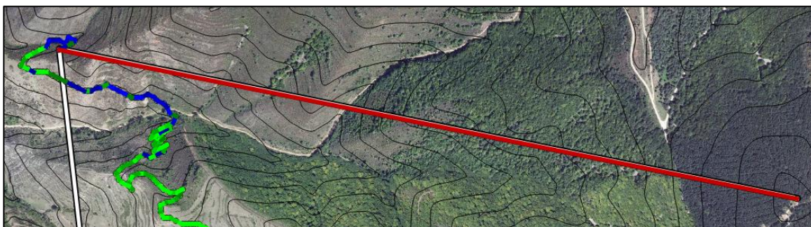
Imagen 3. Caso para el cuál el optimizador no encuentra la ruta óptima. En blanco con borde negro la capa de entrada con los puntos de ruta, en verde-azul la ruta diseñada por la aplicación, en rojo tramo no procesado
